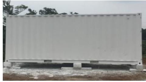
(a) 未塗佈環保隔熱披覆材料試體 (b) 塗佈環保隔熱披覆材料試體
