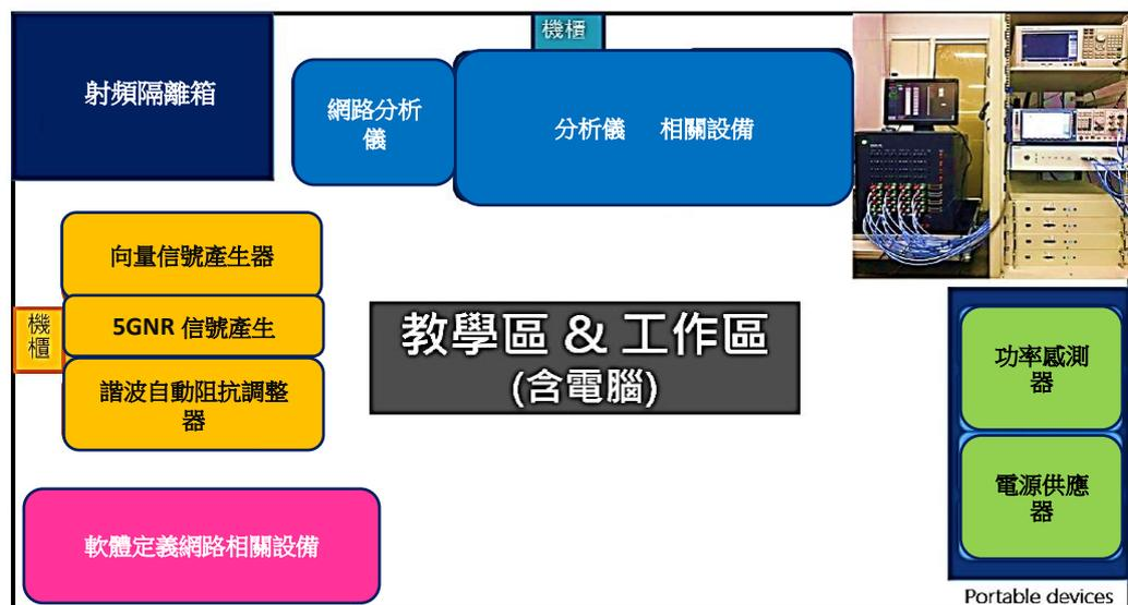
圖 3-11：B5G 開放網路通訊關鍵模組實驗室設備配置規劃圖
