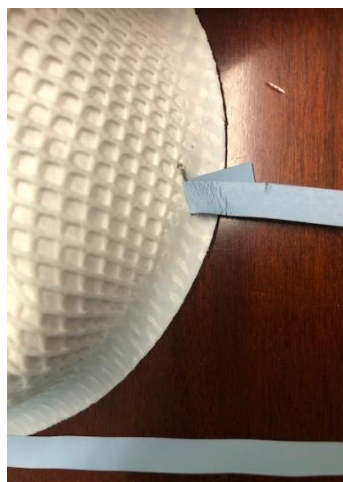
圖五. 鬆緊帶經臭氧處理後有裂痕。
